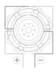
Series D1 :  $2\Omega$  Impedance D2 :  $4\Omega$  Impedance
