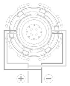
Parallel D1 :  $0.5\Omega$  Impedance D2 :  $1\Omega$  Impedance
